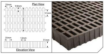
Section Properties per m of Width: A = 2.17x10<sup>4</sup>mm<sup>2</sup> I=4.64x10<sup>6</sup>mm<sup>4</sup> S=1.76x10<sup>5</sup>mm<sup>3</sup>
